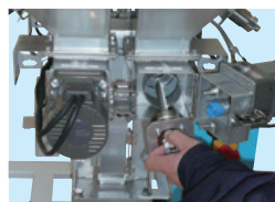
スクリュフィーダ取外し Taking Out The Screw Feeder
