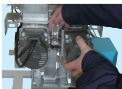
スクリュフィーダモータ部開 Motor Chamber Opens
