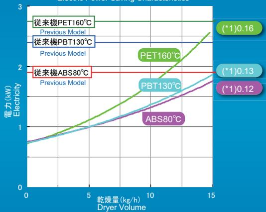
(\*1) 比電力 (kWh/kg) : 原料1 (kg) 乾燥に必要な電力量 (kWh)、15 (kg/h) の時
